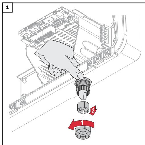
Uvolněte převlečnou matici kabelové vývodky a z vnitřní části přístroje vytlačte ven těsnicí kroužek se záslepkami.
