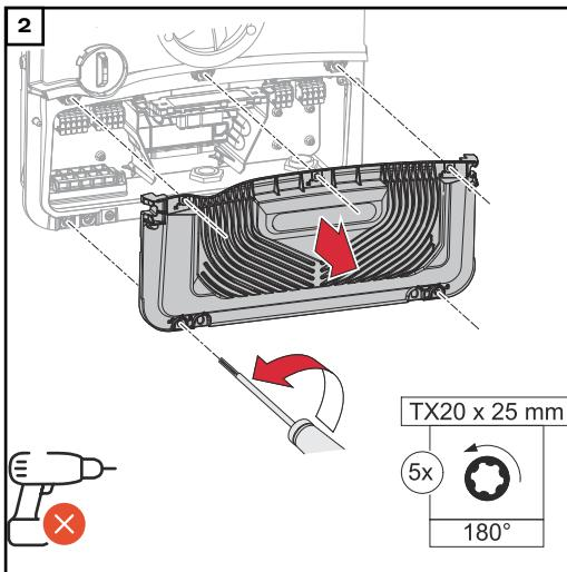
Pomocí šroubováku (TX20) otočte 5 šroubů na krytu připojovací části o 180° doleva a uvolněte je.
