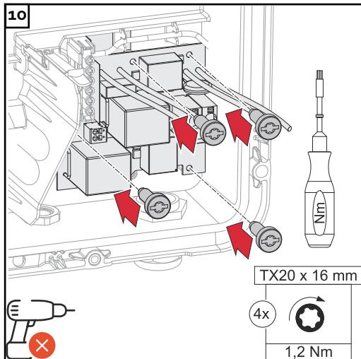
PC-Board připevněte pomocí 4 dodaných šroubů (TX20) utahovacím momentem 1,2 Nm.
