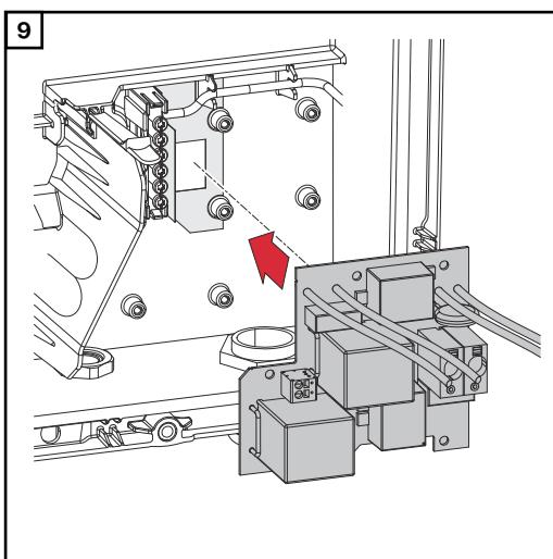
Vložte PC-Board do střídače.
