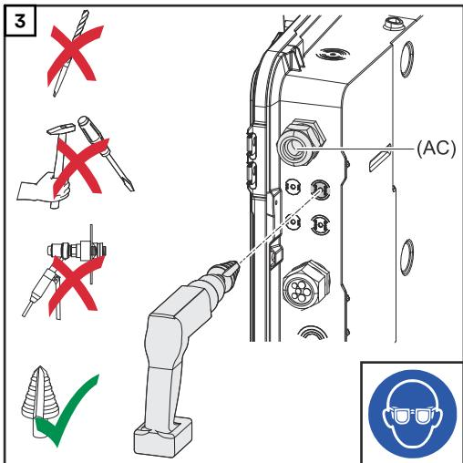
Volitelné kabelové vedení navrtejte stupňovitým vrtákem.
