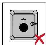
Na svislou stěnu či sloup neinstalujte střídač s přípojkami orientovanými nahoru.
