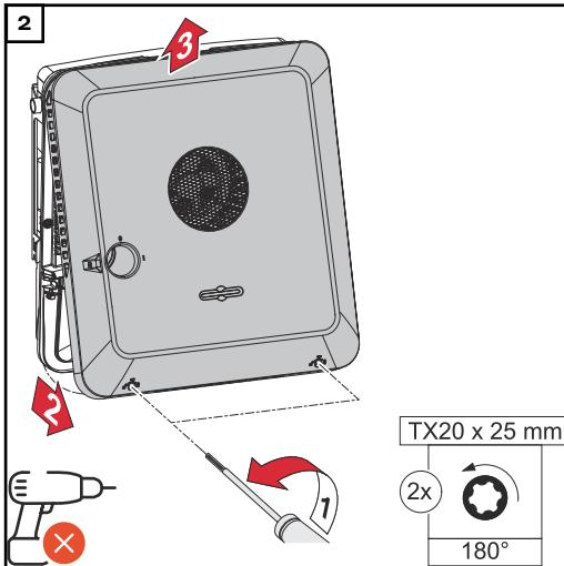
Otočením o 180° doleva pomocí šroubováku (TX20) uvolněte šrouby ve spodní části víka pláště. Potom na spodní straně střídače nadzvedněte víko pláště a směrem nahoru ho sejměte.
