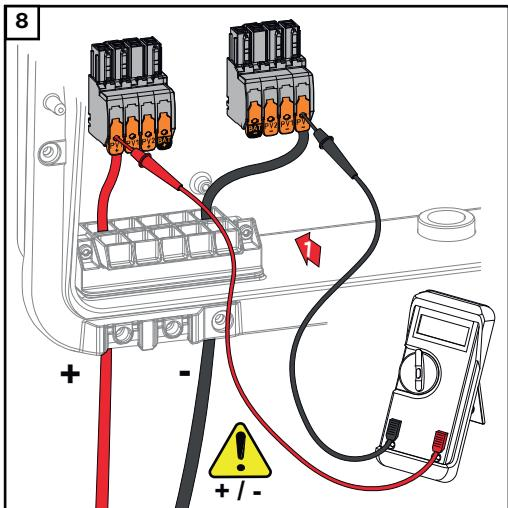
Pomocí vhodného měřicího přístroje zkontrolujte napětí a polaritu kabeláže DC. Vyjměte obě přípojné svorky DC ze zdírek.
