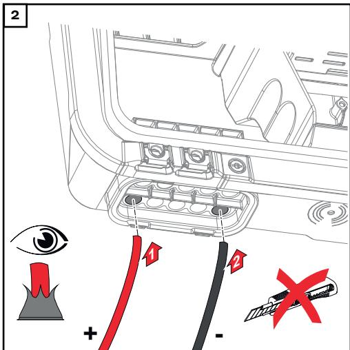
Ručně provlékněte DC kabely skrz DC průchodky.
