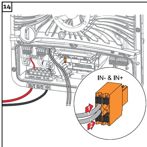
Zapojte signální kabely podle označení na zasouvací přípojně svorce WSD do zdířek IN- a IN+.
