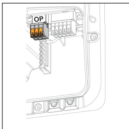
Prostřednictvím bodu PV Point lze při výpadku veřejné sítě na přípojně svorce Opportunity Power (OP) 1fázově napájet elektrické přístroje s maximálním výkonem 3 kW, pokud je pro tyto účely k dispozici dostatek energie z fotovoltaických panelů nebo volitelného akumulátoru. V režimu sítového provozu je tato přípojná svorka OP bez napětí, a proto nejsou připojené spotřebiče napájeny.
