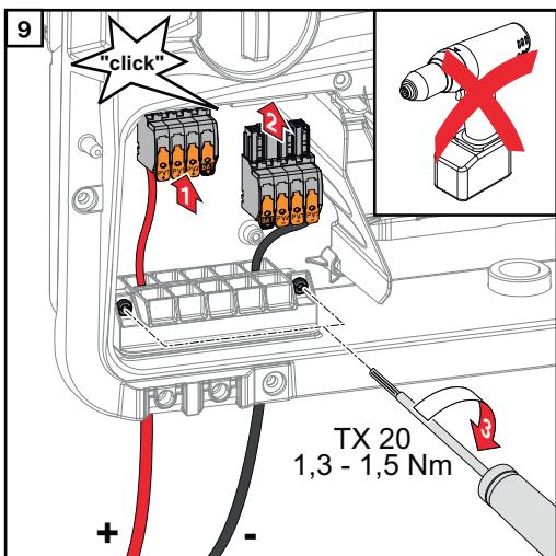
Zasuňte přípojné svorky DC do příslušné zdírky tak, abyste slyšeli začváknutí. Pomocí šroubováku (TX20) připevněte utahovacím momentem 1,3 - 1,5 Nm šrouby odlehčení tahu k plášti přístroje.
