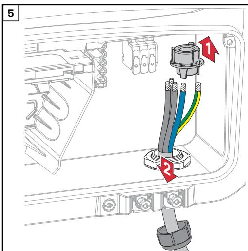
Stáhněte feritové jádro a ze střídače odstraňte napájecí kabel.
