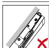
Střídač neinstalujte převisle s přípojkami orientovanými nahoru.
