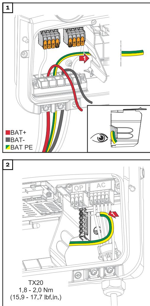
Ochranný vodič akumulátoru vložte do integrovaného kabelového kanálu oddělení připojovací části v připojovací části AC.
