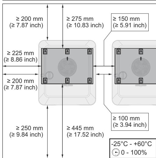
Zařízení instalujte pouze na pevný, nehořlavý podklad.
