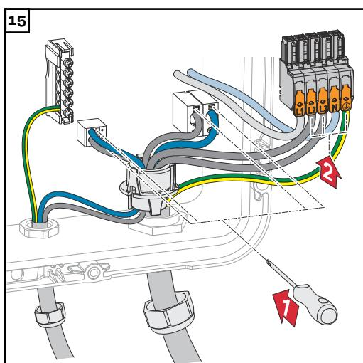
Připojte odizolované fázové vodiče / nulový vodič k dodaným přípojným svorkám.
