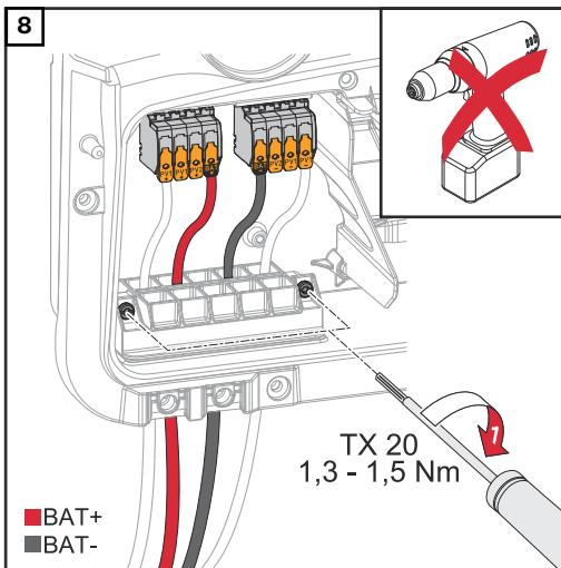
Pomocí šroubováku (TX20) s utahovacím momentem 1,3 - 1,5 Nm připevněte šrouby kabelového vedení k plásti přístroje.
