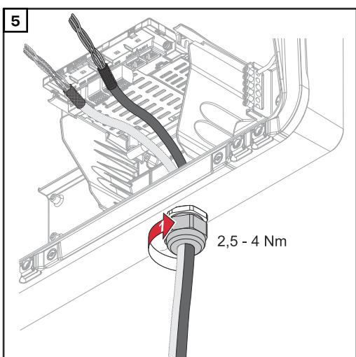
Utáhněte převlečnou matici kabelové vývodky utahovacím momentem v rozsahu 2,5 - 4 Nm.
