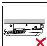
Střídač neinstalujte na strop.
