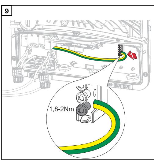
Pomocí šroubováku (TX20) připojte ochranný vodič k prvnímu vstupu ze spodu uzemňovací svorkovnice; použijte utahovací moment 1,8 - 2 Nm.
