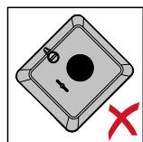
Na svislou stěnu či sloup neinstalujte střídač do šikmé polohy.
