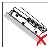
Střídač neinstalujte na šikmou plochu s přípojkami orientovanými nahoru.
