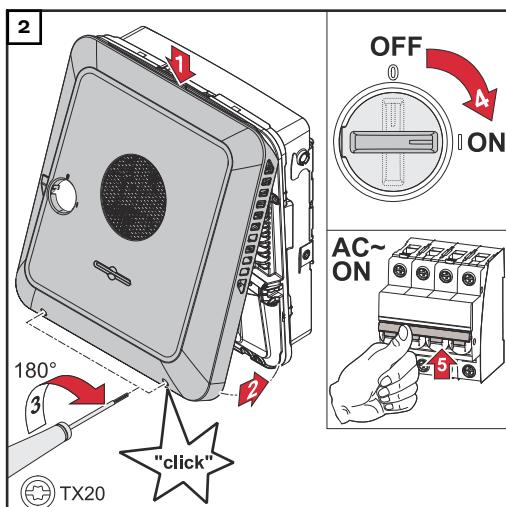
Zavřete víko pláště seshora na střídač. Přitlačte spodní část víka pláště a pomocí šroubováku (TX20) utáhněte 2 šrouby otočením o 180° doprava. Přepněte přepínač odpojovače DC do polohy „Zapnuto“. Zapněte jistič. U systémů s akumulátorem je třeba dodržovat pořadí při zapínání uvedené v kapitole **Vhodné akumulátory** na str. 27.
