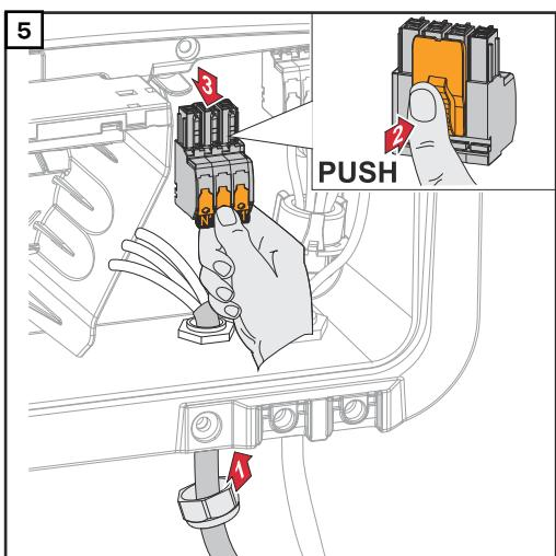
Zespodu protáhněte napájecí kabel kablovou vývodkou.
