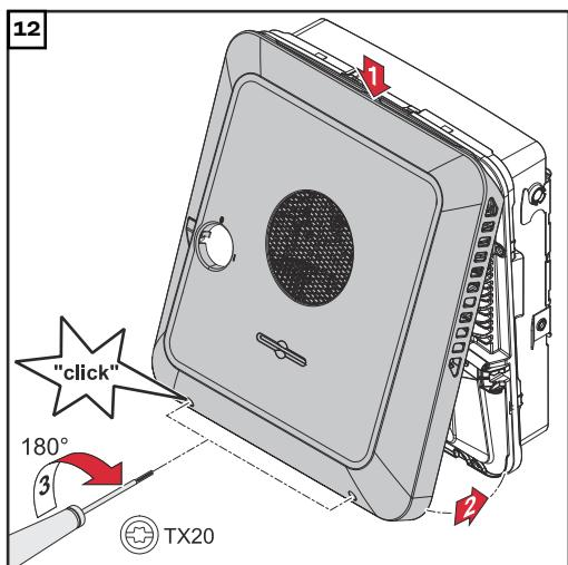
Zavěste víko pláště seshora na střídač. Přitlačte spodní část víka pláště a pomocí šroubováku (TX20) utáhněte 2 šrouby otočením o 180° doprava.
