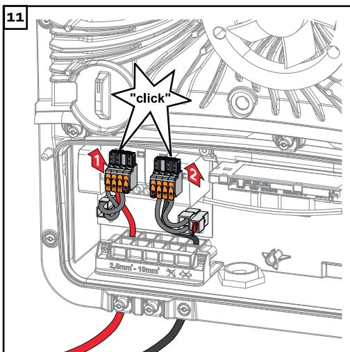
Zasouvací přípojné svorky DC zapojte do příslušných zdírek tak, aby slyšitelně zavakly.
