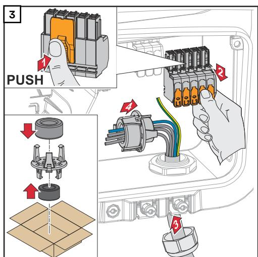
Stiskněte západku na zadní straně přípojně svorky a stáhněte přípojnou svorku AC. Protáhněte napájecí kabel zespodu kablovou vývodkou umístěnou na pravé straně a feritovým jádrem.
