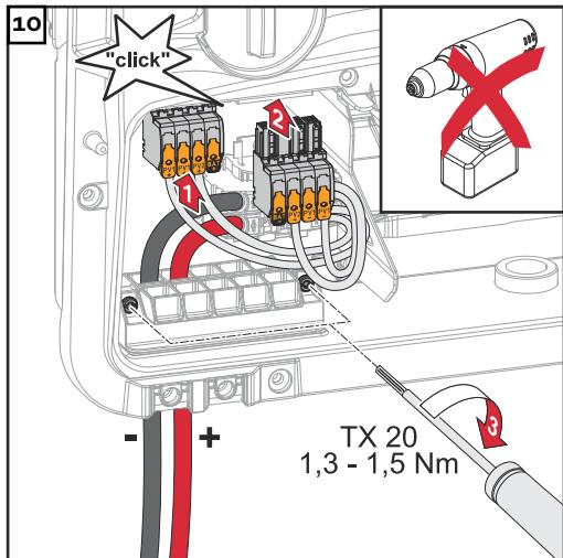
Zasuňte přípojné svorky DC do příslušné zdírky tak, abyste slyšeli zacvaknutí. Pomocí šroubováku (TX20) připevněte utahovacím momentem 1,3 - 1,5 Nm šrouby odlehčení tahu k plásti přístroje.
