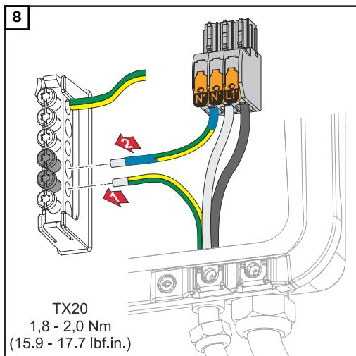
Ochranný vodič a vodič PEN připevněte k uzemňovací svorkovnici pomocí šroubováku (TX20) utahovacím momentem 1,8 - 2 Nm.
