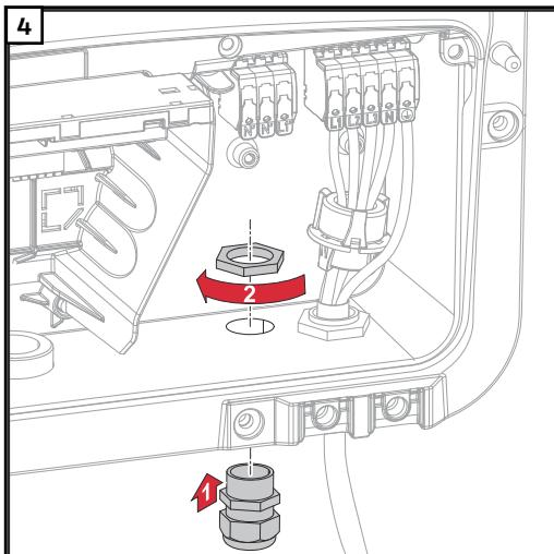
Do otvoru vložte kabelovou vývodku a připevněte ji pomocí utahovacího momentu uváděného výrobcem.
