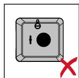
Na svislou stěnu či sloup neinstalujte střídač do vodorovné polohy.
