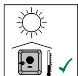
Namontujte střídač do chráněné polohy, např. pod solárními panelemi nebo pod přesahem střechy.
