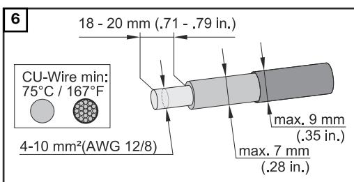
Z jednotlivých vodičů odizolujte 18 - 20 mm izolace.
