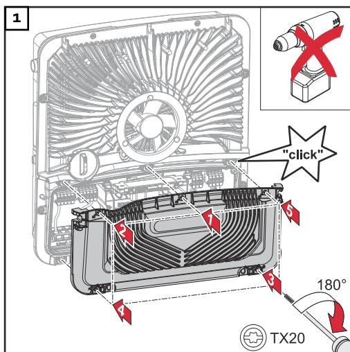
Nasadte kryt na připojovací část. V uvedeném pořadí našroubujte pomocí šroubováku (TX20) všech 5 šroubů a utáhněte je otočením o 180° doprava.
