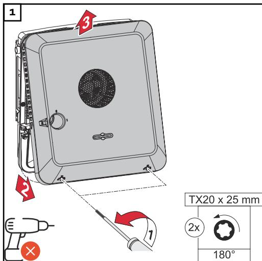
Otočením o 180° doleva pomocí šroubováku (TX20) vyšrouubujte 2 šrouby ve spodní části víka pláště. Potom na spodní straně střídače nadzvedněte víko pláště a směrem nahoru ho sejměte.
