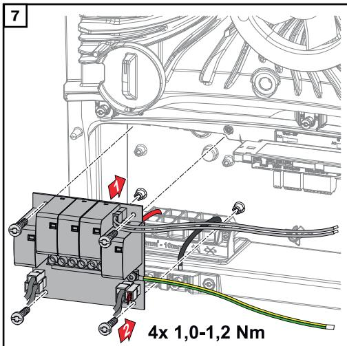
Vložte tištěný spoj do střídače a pomocí 4 dodaných šroubů (TX20) ho připevněte utahovacím momentem 1,0 - 1,2 Nm.
