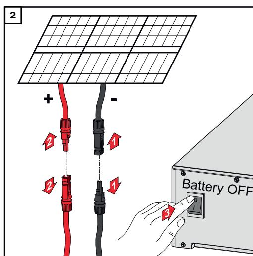
Uvolněte přípojky větví solárních panelů (+/-). Vypněte akumulátor připojený ke střídači.
