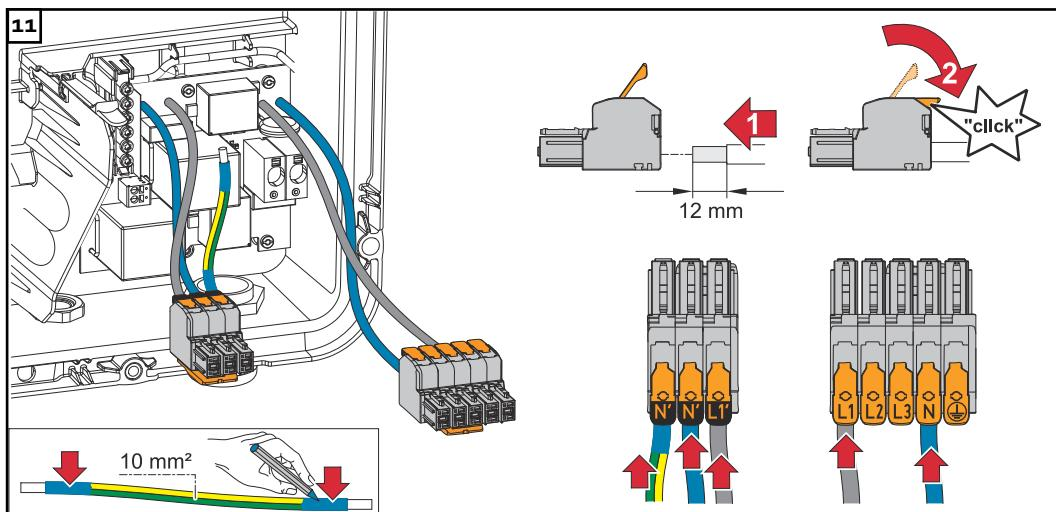
Na konci jednotlivých vodičů odstraňte 12 mm izolace. Nadzvednutím otevřete ovládací páčku přípojné svorky AC a zasuňte odizolovaný vodič do příslušné zdírky přípojné svorky AC až na doraz. Následně zavřete ovládací páčku, až začvakne.
