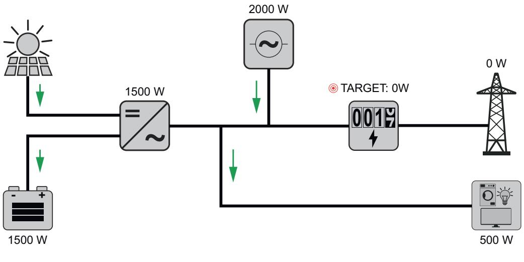
**Příklad: Akumulátorový systém včetně druhého zařízení na výrobu elektrické energie v domě**
