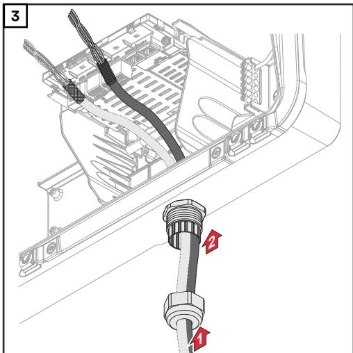
Datový kabel veďte nejdříve převlečnou maticí kabelové vývodky a následně otvorem v plášti přístroje.
