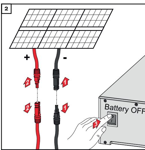
Uvolněte přípojky větví solárních panelů (+/-). Vypněte akumulátor připojený ke střídači.
