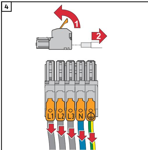
Odpojte jednotlivé vodiče od přípojné svorky AC (nutno pouze u již existující instalace).
