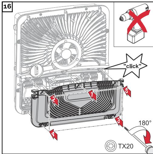
Nasadte kryt na připojovací část.
