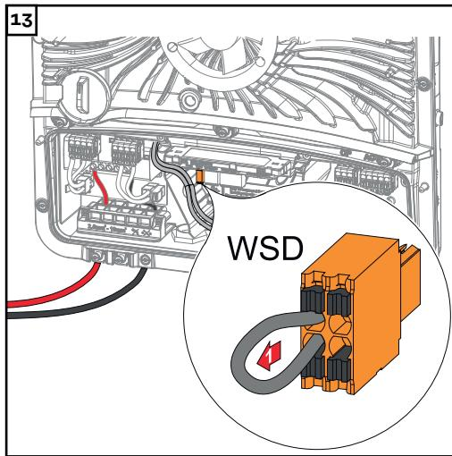
Odstraňte továrně instalované přemostění na přípojné svorce WSD.
