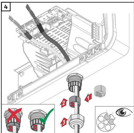
Mezi převlečnou matici a otvor v plášti přístroje nasadte těsnící kroužek. Datový kabel zatlačte do kabelové průchodky v těsnění. Potom zatlačte těsnění až ke spodní hraně kabelové vývodky.
