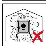
Střídač je standardně prachotěsný (stupeň krytí IP 66). V oblastech s vysokým hromaděním prachu se může na chladicích plochách usazovat prach a tím snížit tepelnou výkonnost. V tomto případě je nezbytné pravidelné čištění, viz kapitola **Provoz ve velmi prašných prostorách** na straně **171**. Instalace v prostorech a okolí s vysokou tvorbou prachu se proto nedoporučuje.
