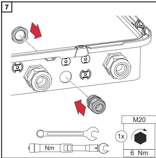
Do otvoru vložte kabelovou vývodku a upevněte ji utahovacím momentem 6 Nm.
