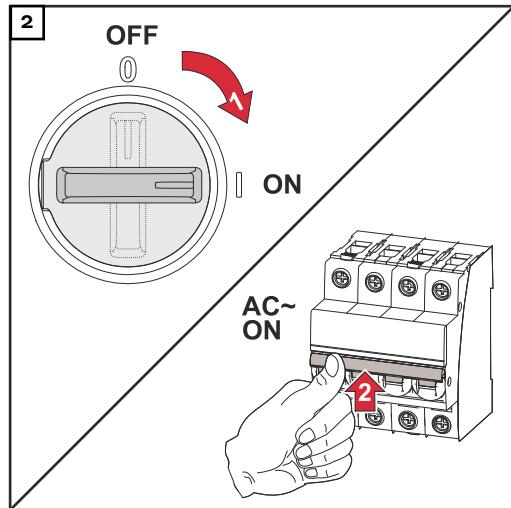
Přepněte přepínač odpojovače DC do polohy „Zapnuto“. Zapněte jistič.
