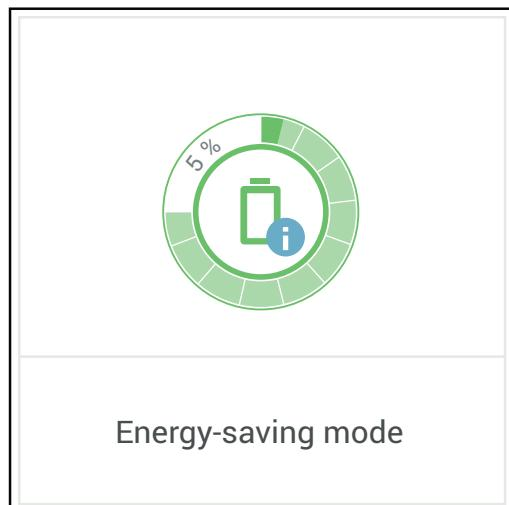
Energeticky úsporný režim je v přehledu systému na uživatelském rozhraní střídače a na portálu Fronius Solar.web označen písmenem „i“ umístěným vedle symbolu akumulátoru.
