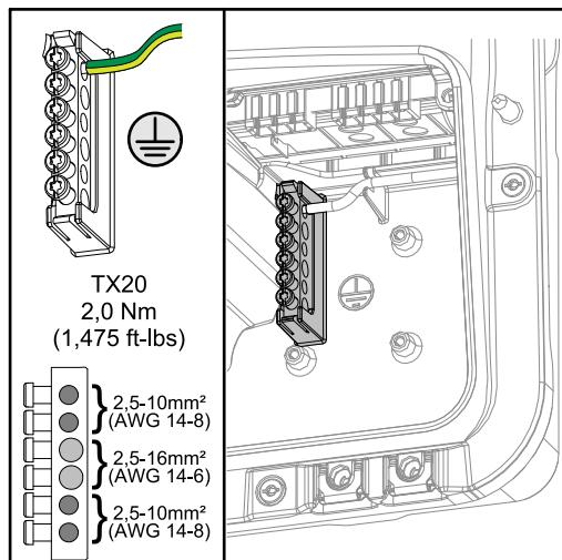
Uzemňovací svorkovnice nabízí možnost uzemnit další komponenty, jako jsou např.:
