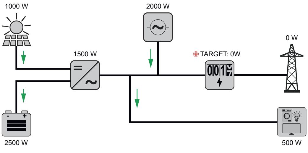
**Příklad: Akumulátorový systém včetně druhého zařízení na výrobu elektrické energie v domě (s omezením AC max.)**
