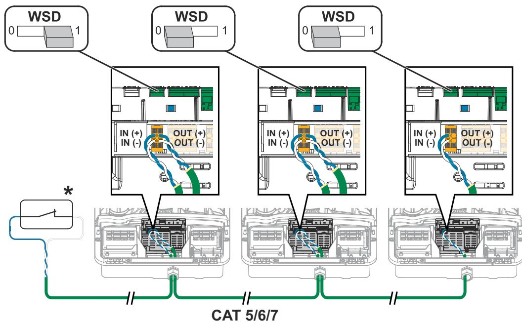
\* Beznapěťový kontakt spouštěcího zařízení (např. centrální ochrana sítě a systému). Při použití několika beznapěťových kontaktů v řetězci WSD je třeba tyto kontakty zapojit sériově.
