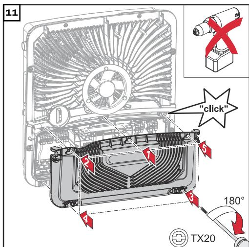
Nasaděte kryt na připojovací část. V uvedeném pořadí našroubujte pomocí šroubováku (TX20) všech 5 šroubů a utáhněte je otočením o 180° doprava.
