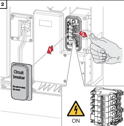
Stáhněte kryt odpojovače DC směrem dopředu. Přepněte přepínač odpojovače DC do polohy „Zapnuto“.
