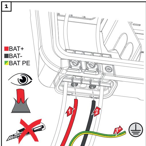
Ručně provlékněte kabely akumulátoru skrz průchodky pro DC kabely.
