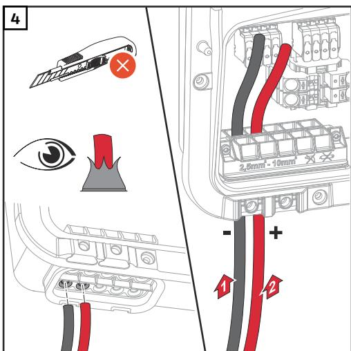
Ručně provlékněte DC kabely skrz DC průchodky.
