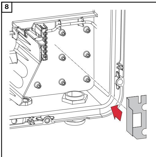
Vložte izolační fólii na pravou stranu uzemňovací svorkovnice.
