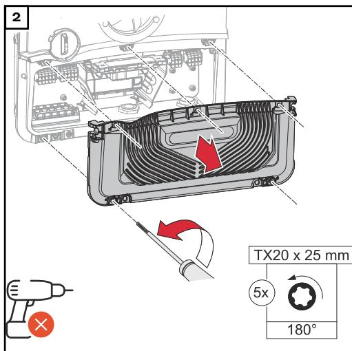
Pomocí šroubováku (TX20) otočte 5 šroubů na krytu připojovací části o 180° doleva a uvolněte je. Sejměte kryt připojovací části z přístroje.
