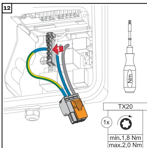
Vodič PEN připevněte k třetímu vstupu zdola na uzemňovací svorkovnici pomocí šroubováku (TX20) utahovacím momentem 1,8 - 2 Nm.
