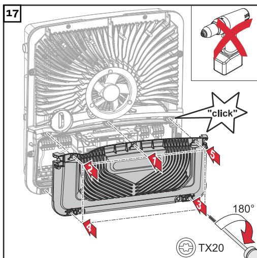
Nasadte kryt na připojovací část.
