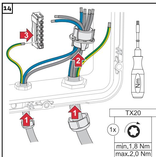
Fázové vodiče / nulový vodič protáhněte feritovým jádrem.
