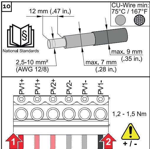
Na konci jednotlivých vodičů odstraňte 12 mm izolace a vodiče připevněte v příslušné zdířce přípojné svorky na tištěném spoji utahovacím momentem 1,2 - 1,5 Nm.
