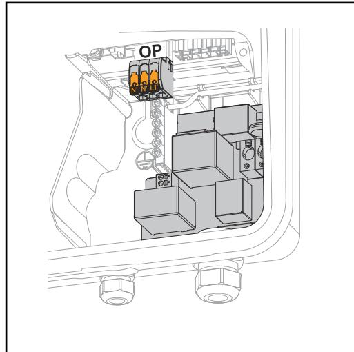
PV Point Comfort zajišťuje trvalé napájení jednofázových elektrických zařízení do maximálního výkonu 3 kW. Přepínáním mezi síťovým a záložním napájením probíhá automaticky. V případě výpadku veřejné sítě nebo střídače jsou spotřebiče na PV Point Comfort trvale napájené. Když je opět k dispozici veřejná síť a je zajištěna stabilita, PV Point Comfort automaticky přepne na síťový režim, záložní napájení se ukončí.
