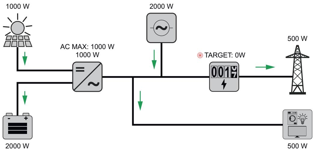
**Povolená pravidla pro řízení akumulátoru**
