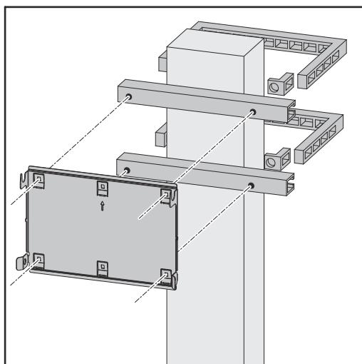
Při montáži střídače na sloupek nebo na nosník doporučuje společnost Fronius použít připevňovací sadu „Pole clamp“ (Obj. č. SZ 2584.000) od spo- lečnosti Rittal GmbH.
