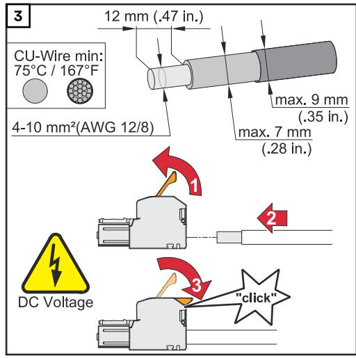
Průřez kabelu vyberte podle údajů uvedených v části **Přípustné kabely pro elektrické připojení** od str. 65.
