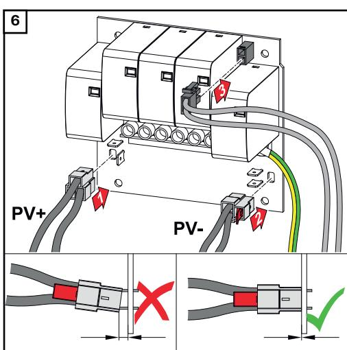
Připojte dodané kably k příslušným přípojkám na tištěném spoji.
