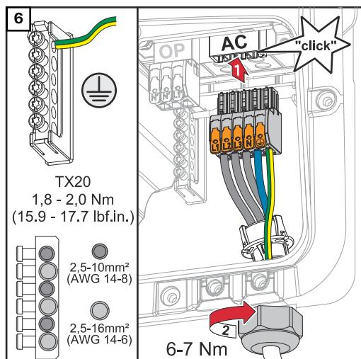
Zasuňte přípojnu svorku AC do zdírky AC tak, abyste slyšeli zacvaknutí. Utáhněte převlečnou matici kabelové vývodky utahovacím momentem 6 - 7 Nm.
