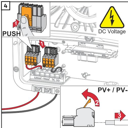
Vytáhněte zasouvací přípojné svorky DC ze zdírek a odpojte je od kabelů (nutno pouze u již existující instalace).
