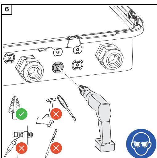
Volitelné kabelové vedení navrťte stupňovitým vrtákem.
