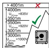
Je zakázáno instalovat a provozovat střídač v nadmořské výšce vyšší než 4 000 m.
