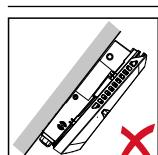
Střídač neinstalujte převisle s přípojkami orientovanými dolů.
