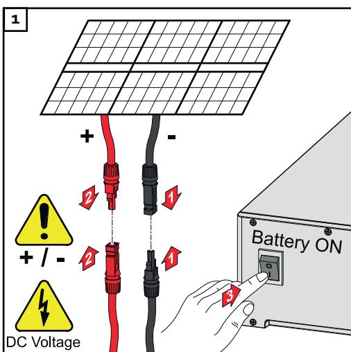
Připojte větve solárních panelů (+/-). Zapněte akumulátor připojený ke střídači.
