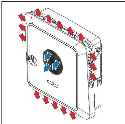
Ventilátor umístěný v přední části zařízení nasává okolní vzduch a na bocích zařízení dochází k odvodu vzduchu. Rovnoměrný odvod tepla umožňuje instalaci více střídačů vedle sebe.
