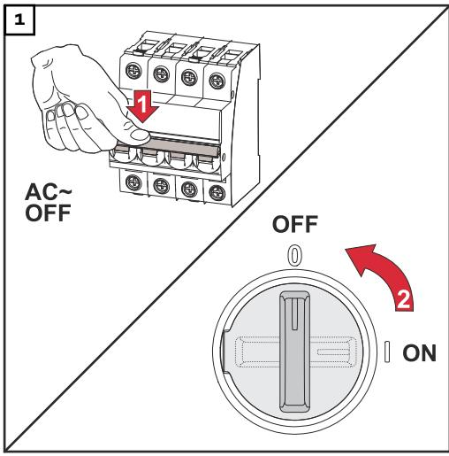
Odpojte střídač od napájení a vyčkejte, až se zastaví ventilátor a až se vybijí kondenzátory střídače (2 minuty). Přepněte přepínač odpojovače DC do polohy „Vypnuto“.
