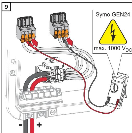
Pomocí vhodného měřicího přístroje zkontrolujte napětí a polaritu kabeláže DC.
