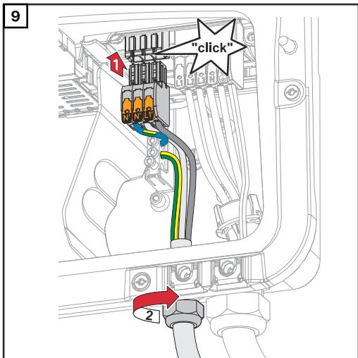
Zasuňte přípojnou svorku OP do zdírky OP tak, abyste slyšeli zacvaknutí. Připevněte převlečnou matici kabelové vývodky pomocí utahovacího momentu uváděného výrobcem.
