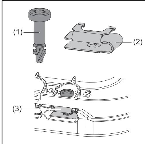
K montáži krytu připojovací části i předního krytu se používá systém s rychlouzavěrem (3). Systém se otvírá a zavírá pootočením šroubu s pojistkou proti ztrátě (1) o půl otáčky (180°) v pružině rychlouzavéru (2).
