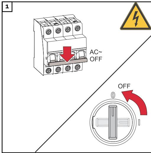
Vypněte jistič. Přepněte přepínač odpojovače DC do polohy „Vypnuto“.
