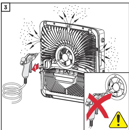
Nahromaděné nečistoty na chladiči a ventilátoru odstraňte pomocí stlačeného vzduchu, hadříku nebo štětce.
