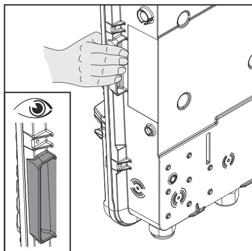
Na boku střídače jsou integrované úchyty, které usnadňují zvedání/zavěšování.
