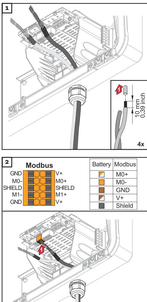
Z jednotlivých vodičů odstraňte 10 mm izolace a na odizolované části případně nasadte kabelové zakončovací dutinky.
