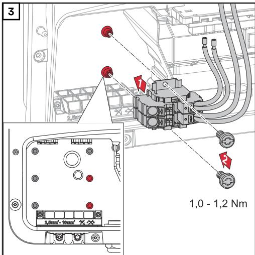
Vložte DC Connector GEN24 do střídače a pomocí 2 dodaných šroubů (TX20) ho připevněte utahovacím momentem 1,0 - 1,2 Nm.
